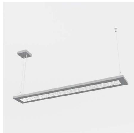
**Cablaggio:** alimentazione 220-240V 50/60Hz con cavetto rigido, sez. 0,50 mm<sup>2</sup> e guaina in PVC-HT resistente a 90°C secondo le norme CEI 20-20. Morsetteria con massima sezione dei cavi ammessa 2,5 mm<sup>2</sup>. Classe di isolamento I. Adatto per essere installato su superfici normalmente incombustibili.
